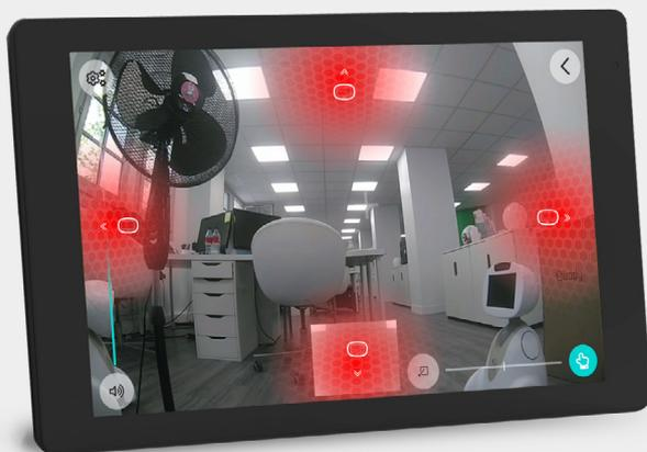
Quand le robot bute sur un obstacle en avançant ou reculant en tournant
